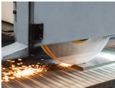
平面研削は、多くの産業で使用され、均一な表面仕上げを達成するための最適な工程です。工具とワークピースの熱変形を最小限に抑え、高い表面品質を保証します。
