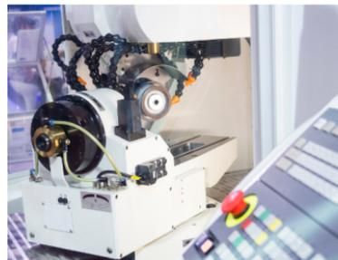
ガードナー研削は特に複雑な形状加工に適しており、製品の高精度な輪郭形成を実現します。この技術は、精密部品のプロファイリングに最適です。
