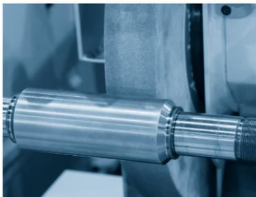
円筒研削は、シャフトやロールなどの部品の外径を高精度で仕上げます。円筒形状の均一性を保ちながら、寸法と形状の高い安定性を提供します。
